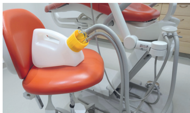
Figure 5 – Exemple de nettoyage du système d'aspiration avec une solution détergente désinfectante aspirée à l'aide d'un dispositif spécifique permettant le raccordement des aspirations et la production d'un mélange air-eau qui améliore l'efficacité du nettoyage.
